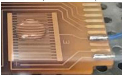
Auf die Kammstruktur E des IPC-Testboards wird ein 0,5ml-Trinkwasser-Tropfen mit der Pipette aufgesetzt und dann über einen Zeitraum von 15 Minuten der elektrische Widerstand gemessen.
